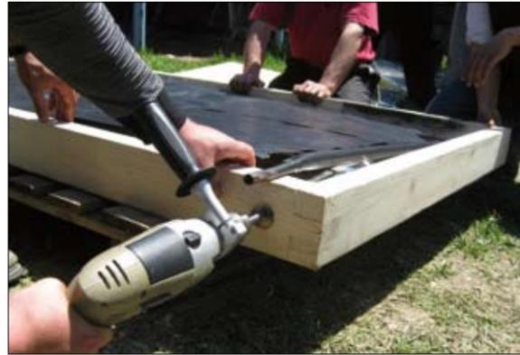
**Шаг 9.** Просверлите входные и выходные отверстия для труб в деревянной раме.
