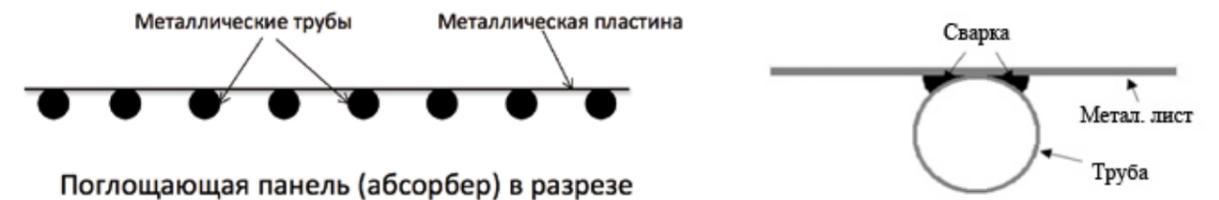
Все соединения различных элементов поглотителя выполнены методом сварки. Для лучшей передачи тепла от металлической пластины к трубам очень важен тип соединения. Поэтому сварка должна производиться вдоль всего элемента, а не точно. Важно, чтобы металлический лист и трубы плотно прилегали друг к другу. Другие соединения, кроме сварки (например, с помощью проволоки) не достаточно, так как они намного менее эффективны. На рисунке справа вверху представлено сечение с указанием мест сварки.
