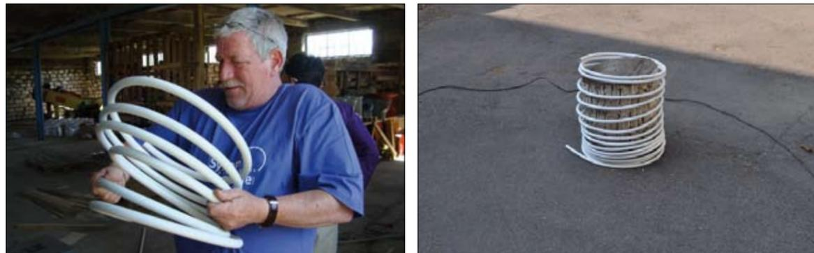
**Шаг 1.** Изготовьте теплообменник. Диаметр спирали должен быть не намного меньше диаметра бака, а диаметр металлопластиковой трубы для теплообменника должен соответствовать диаметру горизонтальных труб абсорбера. При сгибании спирали следует проследить, чтобы труба не имела заломов и жидкость могла свободно циркулировать.
