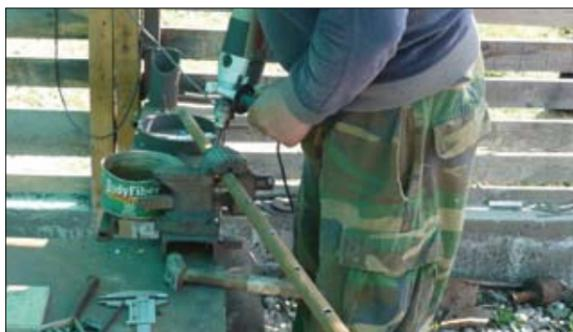
**Шаг 5.** Просверлите по 8 отверстий диаметром 14 мм в обеих металлических трубах 3/4" на расстоянии 11 см друг от друга (см. схему)
