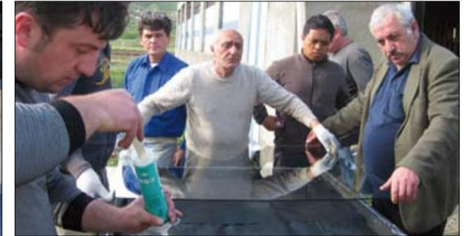
**Шаг 12.** По краю стекла установите резиновый П-образный уплотнитель. Накройте раму стеклом толщиной 4 мм, прикрепив его по периметру рамы с помощью силикона. Аккуратно прижмите и прикрутите алюминиевый монтажный уголок 35x20 для крепления стекла к раме. Самый простой вариант - крепление стекла с только помощью силикона.
