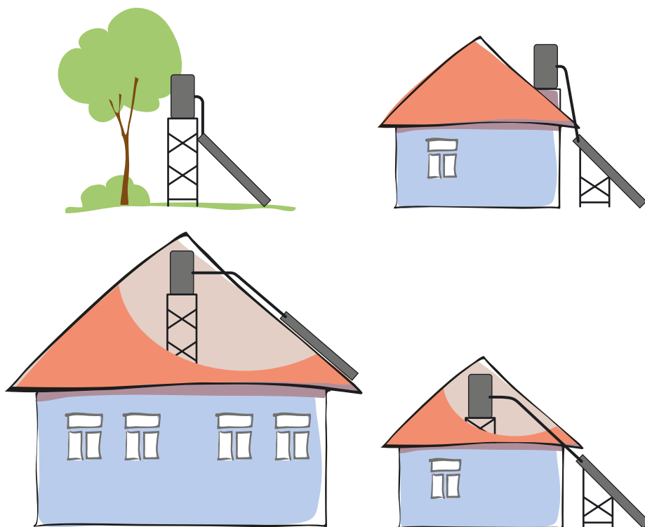
Figura 13. Exemple de amplasare a instalației solare
