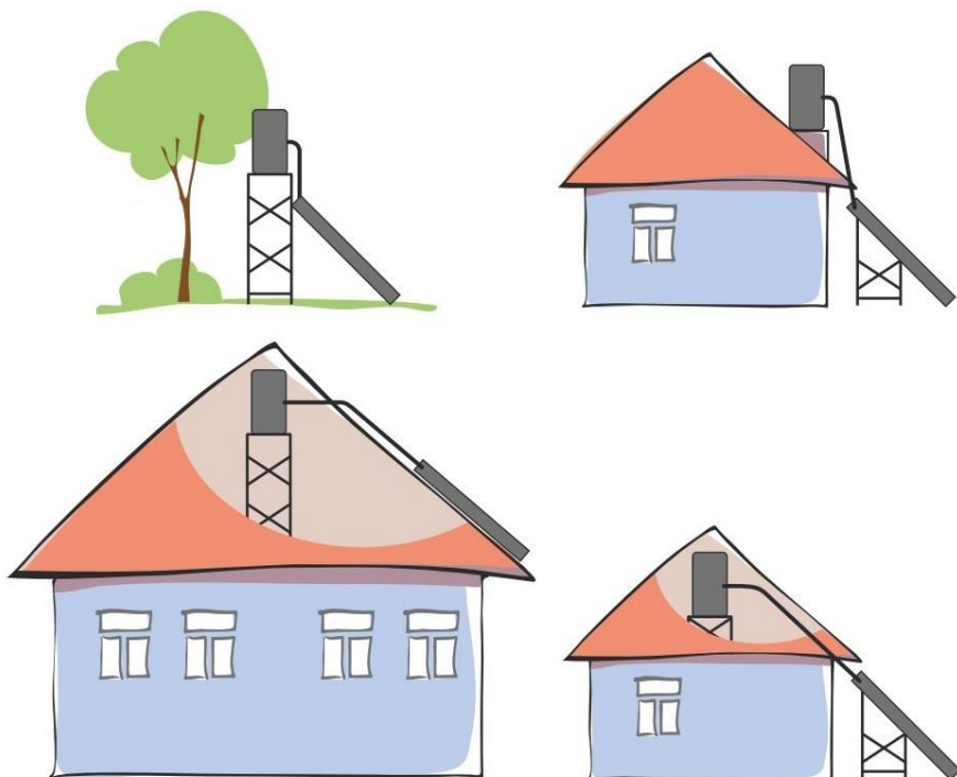
Figura 17. Exemple de amplasare a instalației solare
